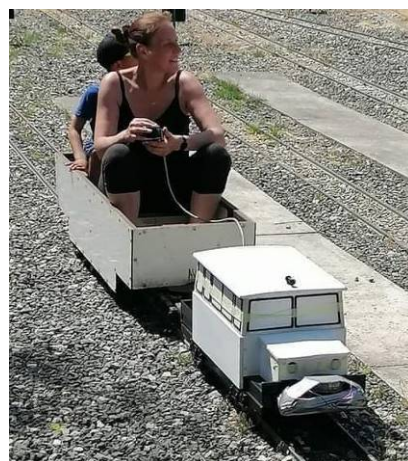
La carrosserie est réalisée à partir de plaque PVC de parois de douche
